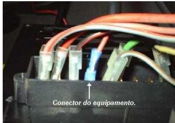
Alimentação do modulo retirada do conector original do veículo.
