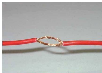
Desencapse o fio de alimentação do veículo dividindo o condutor em duas partes.
