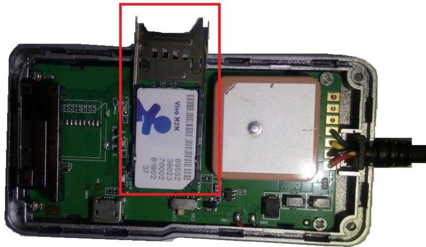
Há uma chave ON / OFF para a bateria de backup na placa, verifique se a mesma está ligada. A bateria de backup é capaz de alimentar o equipamento se não tiver conectado em uma fonte de alimentação.
