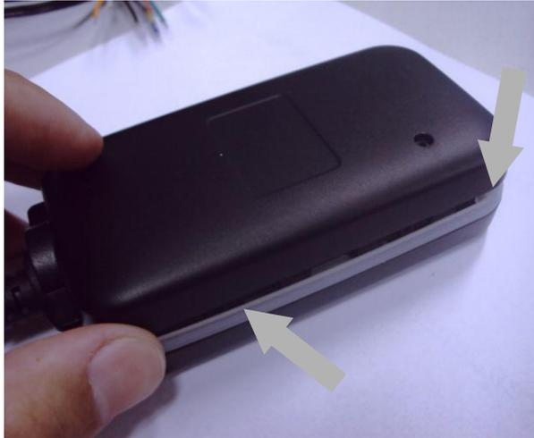
7. Encaixar os dois parafusos Torx modelo T5 utilizando torque de 1.2 a 1.4 N.m para garantir a vedação do produto na região do cabo.
