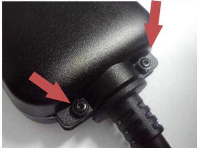
2. Com o auxílio de uma palheta ou objeto plástico, deve-se fazer um esforço mecânico na tampa superior na região das abas laterais aos parafusos para destacá-la;
