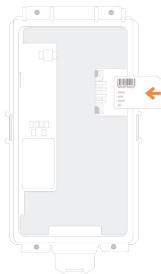
O SIMCard deve ser inserido com os conectores metálicos voltados para baixo e chanfro voltado para fora do equipamento
