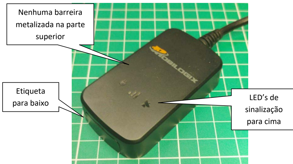
Figura 9 - Posição de instalação do rastreador
