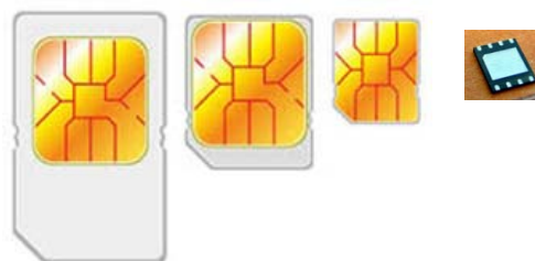
Figura 5 - Da esquerda para a Direita - Regular, Micro, Nano, Embedded
