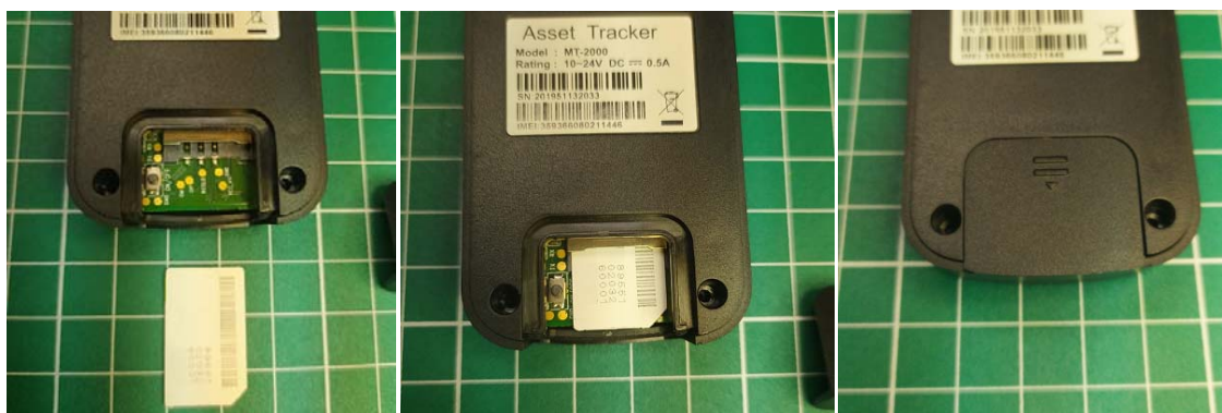
Figura 8 - Finalizando a instalação do SIM-CARD
