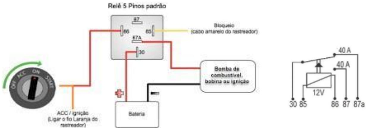
Figura 6 – Instalação do Relé para corte da bomba de combustível
