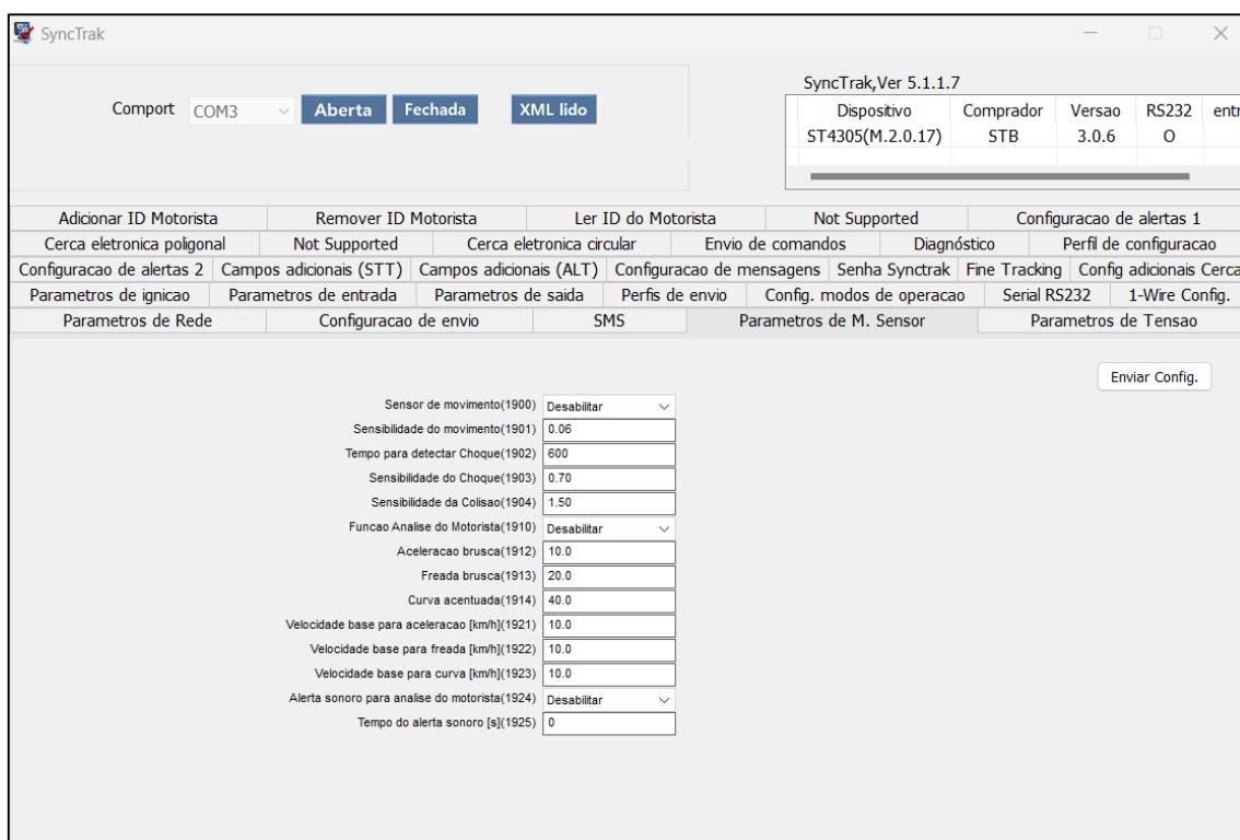
**Sensor de movimento (1900):** Configura as funções do sensor de movimento.
