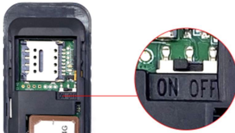
Figura 5 – Esquema de switch ON/OFF
