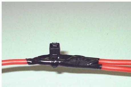
Isolar e prender a emenda com fita isolante ou cinta plástica.
