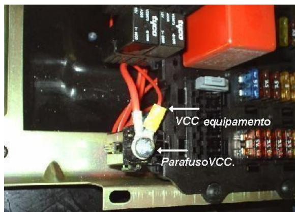
Alimentação do modulo retirada do parafuso de fixação localizado na caixa de fusível.
