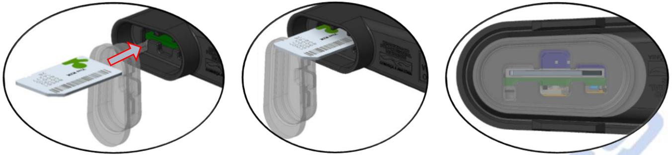
Independente de houver ou não a tampa plástica acima da tampa de silicone a inserção do SIM Card é a mesma.
