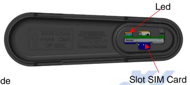
Há dois modelos de caixa do RT305/RT325, onde o que os difere é a tampa plástica que trava com parafuso a entrada do slot do SIM Card.
