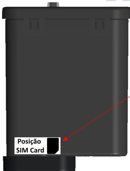
Há um adesivo indicando a posição correta para inserção do SIM Card no rastreador
