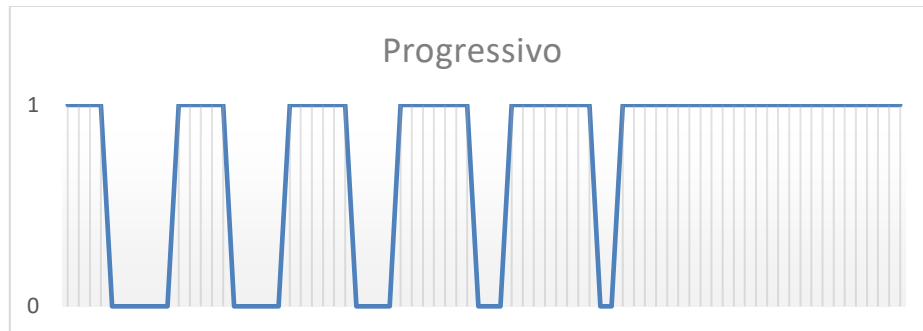
Figura 1- Exemplo Bloqueio progressivo
