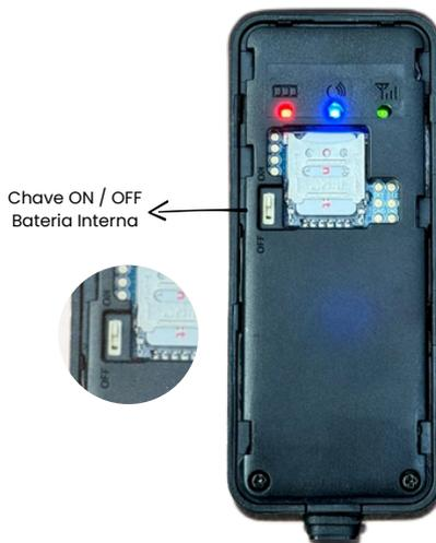
Figura 4: Chave On Off da bateria interna.
