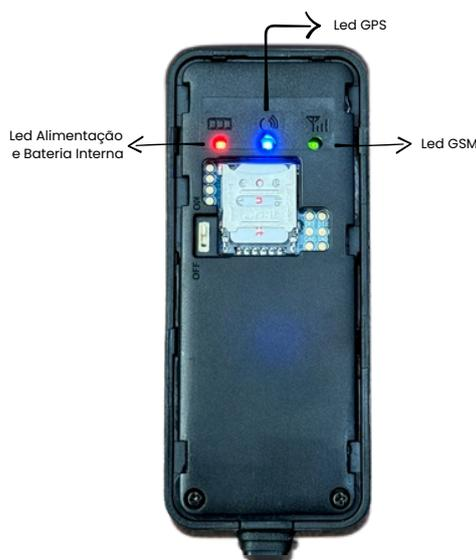
Figura 4: Identificação dos Leds.
