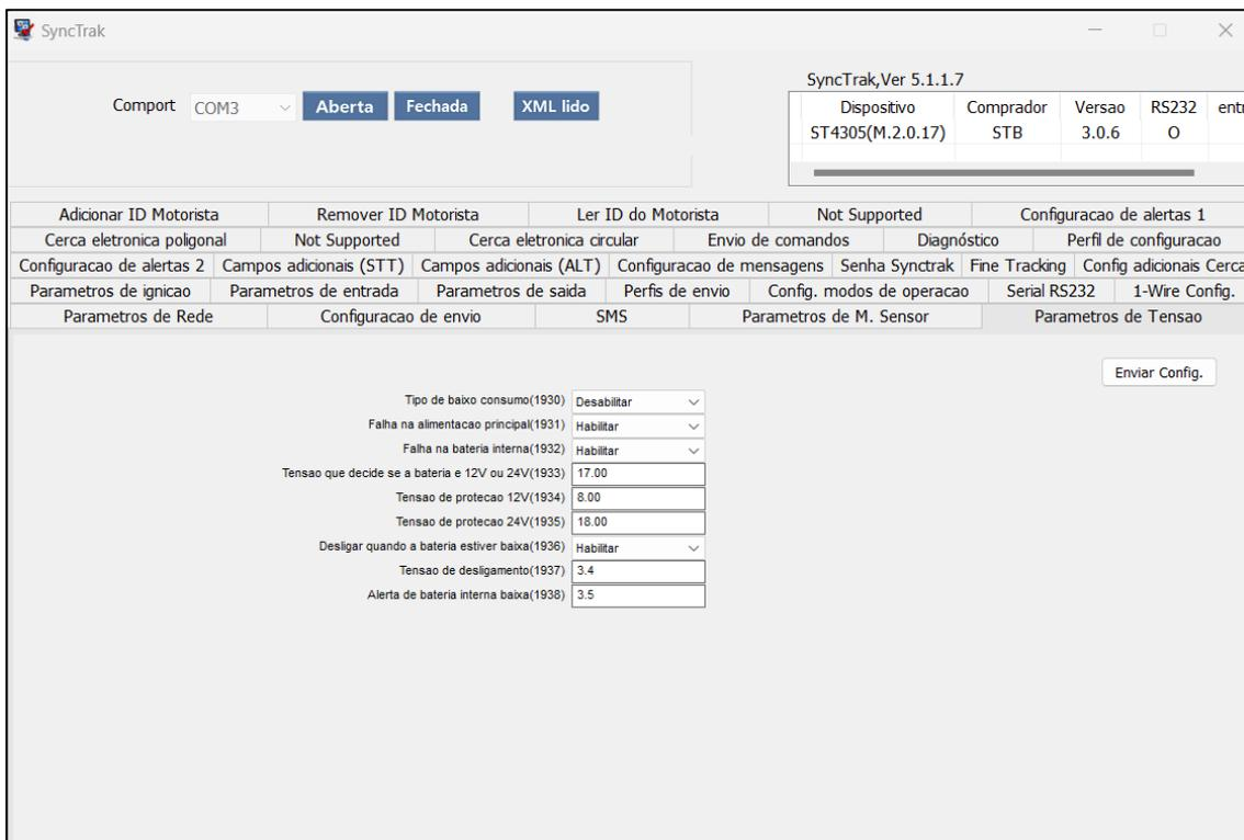
**Tipo de baixo consumo (1930):** Função utilizada para diminuir o consumo típico do equipamento, recomendado para configurações de instalação em motos.
