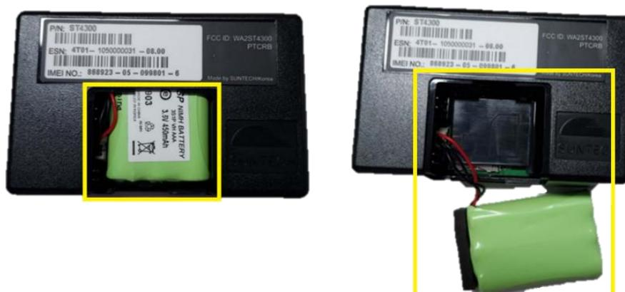
Após a remoção da bateria, insira o Cartão SIM conforme a imagem abaixo.
