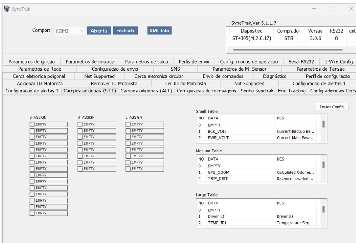
É possível configurar os dados e as informações adicionais que serão transmitidos nas posições do dispositivo. Esta configuração é realizada através do menu **ASSIGN HEADER (STT)** do configurador Synctrak. Existem 3 classificações de informações adicionais que podem ser adicionados a posição e classificamos conforme as tabelas, small table, medium table e large table.
