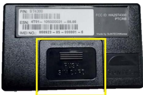
Retire a bateria interna deslocando para fora do produto, conforme a imagem.
