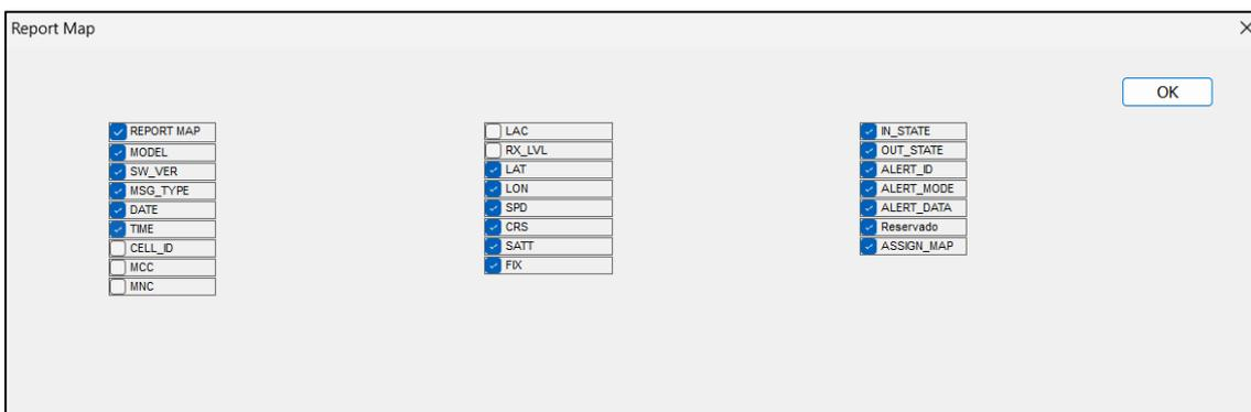
Para configurar a mensagem RS232 (UEX – do equipamento para o servidor) clique em **SET**, uma sub menu será apresentado para que sejam selecionadas as informações que deseja configurar a posição. Adicione ou remova o **checkbox** nos dados que desejar configurar e clique em **OK**
