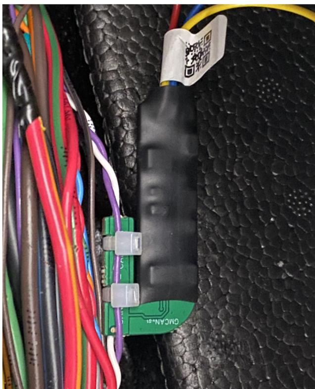
**Foto 6 - Abraçadeiras posicionadas fechadas e cortadas**
